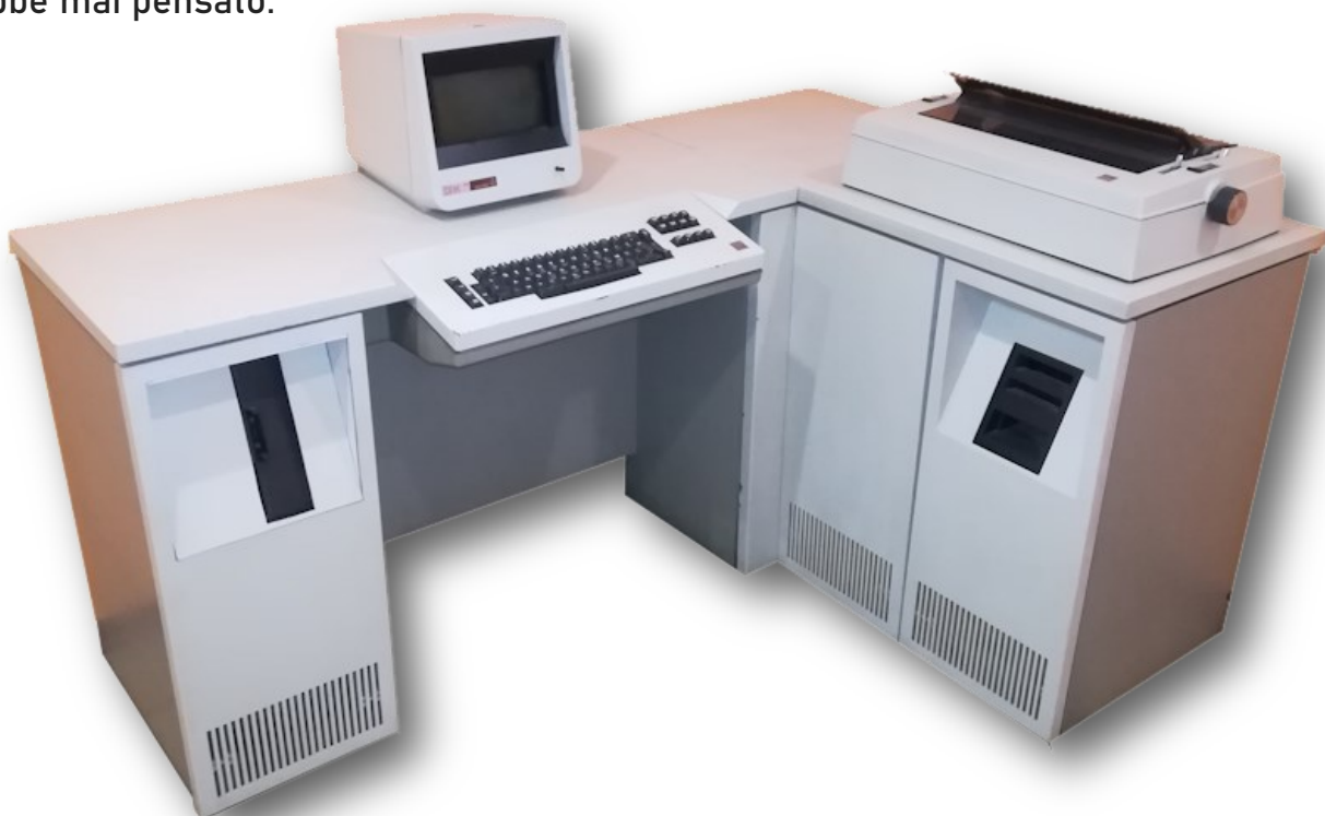
L'Office System 6/452 del nostro Museo. Sul lato sinistro il lettore di floppy da 8 pollici, mentre sul lato destro, sotto la stampante a margherita, è visibile il doppio dispositivo Mag Card (lettore e registratore).
