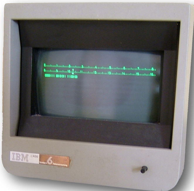
Il monitor, di dimensioni veramente ridotte, utilizzabile dall'operatore per editare i contenuti digitati tramite la tastiera.
